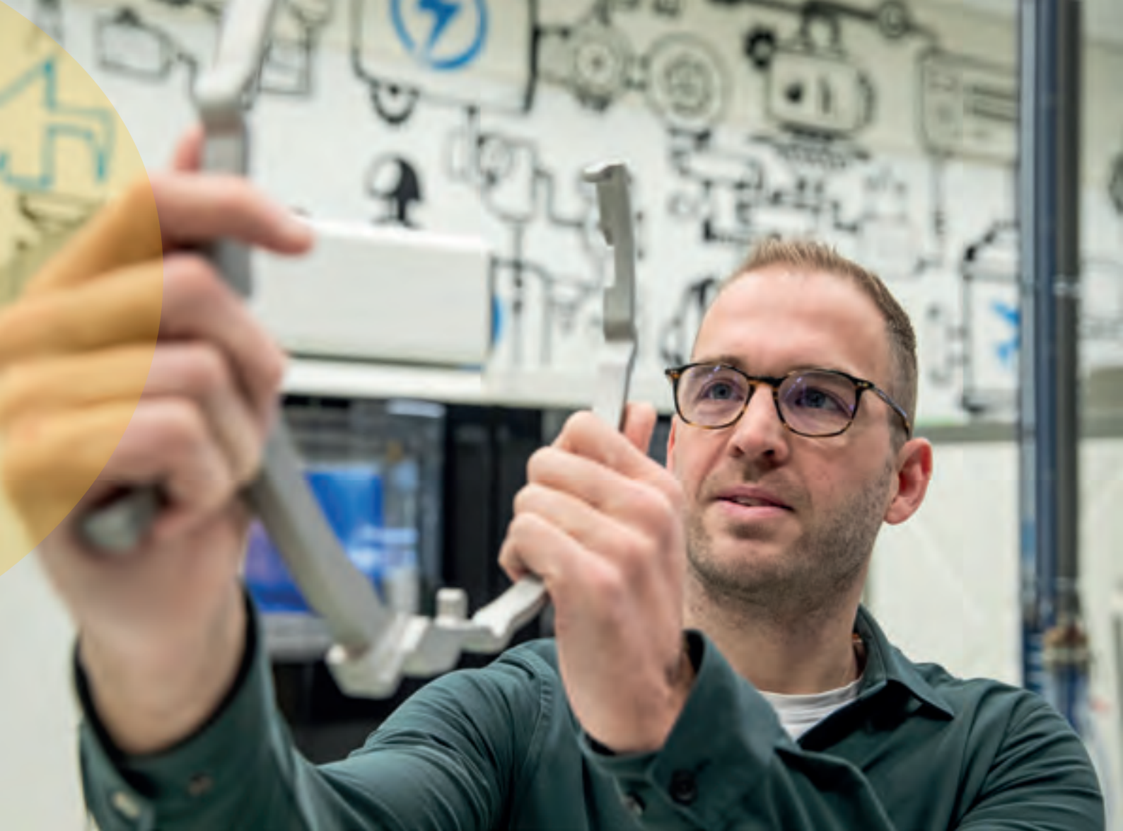
JOCHEM AARNINK, MANAGER OPERATIONS ADDITIVE MANUFACTURING BIJ NTS MET IN ZIJN HAND EEN 3D-GEPRINTE VACUÛMGRIPPER MET INWENDIGE KANAALTJES WAARMEE IN DE SEMICON INDUSTRIE WAFERS WORDEN OPGEPAKT.
