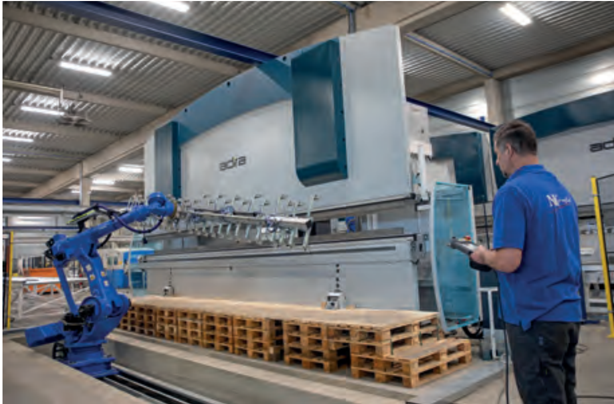
Operator Emil maakt een programma voor de robot van de kantbank 8 meter om een C-profiel van 7 meter te zetten.
