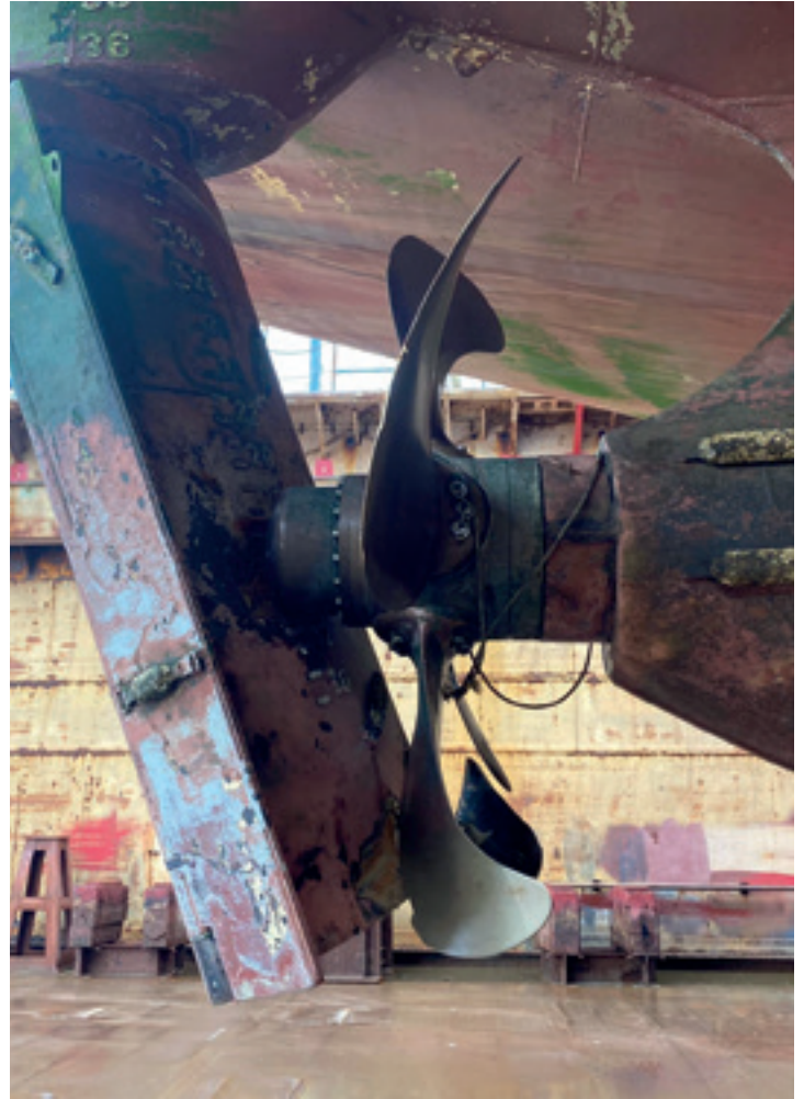
Schroefschade veroorzaakt door inslag van het roer.
