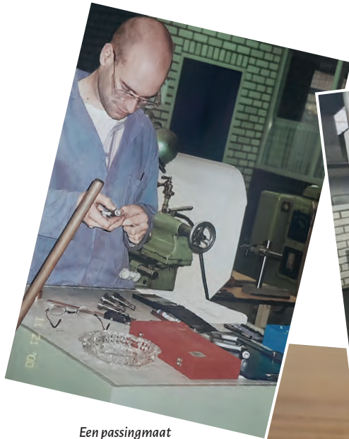
Een passingmaat draaien op de Al-draaibank.
